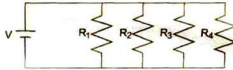
Las resistencias  $R_1$ ,  $R_2$ ,  $R_3$  y  $R_4$  de cada uno de los carros son iguales, y su valor es  $R$ . La pista está alimentada por una pila que entrega un voltaje  $V$ . La pista con los carros en movimiento se representa mediante el
